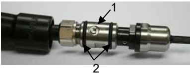
Image 6: Graisseur au-dessous du tourillon; il faut pousser la poignée pour y accéder.
