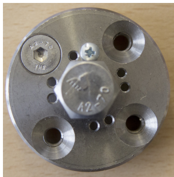
Image 9. Extrémité pour fixer les chaînes avec vis hexagonale, protégé contre torsion avec une vis de blocage M3, 4 mm
