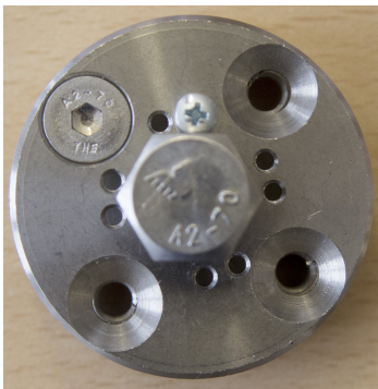
Abb. 12. Kettenkopf mit Sechskantschraube, durch Sicherungsschraube M3, 4 mm gegen Verdrehen gesichert
