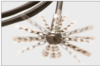
Abb. 5: Kettenkopf durch Bohrmaschine angetrieben
