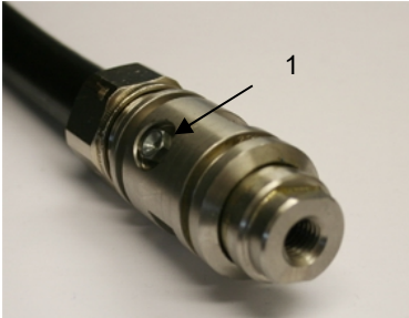
Abb. 6: Gewindeanschluss Kettenkopf mit Schmiernippel
