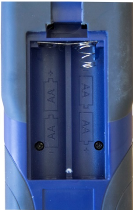
Fig. 21: Vano pile aperto
