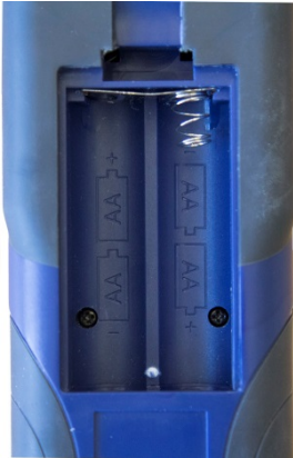
Abb. 6: Geöffnetes Batteriefach auf der Geräterückseite
