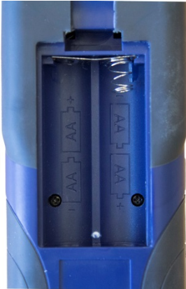
Afb. 26: Geopend batterijenvak aan de achterzijde van het apparaat
