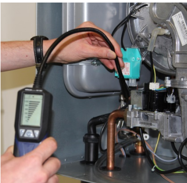
Abb. 5: Der Gasspürer zeigt ein deutliches Signal, wenn er an den leicht geöffneten Messstutzen gehalten wird.
