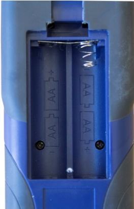
Abb. 6: Geöffnetes Batteriefach auf der Geräterückseite
